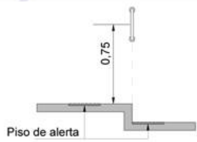
b) Barra de apoio vertical
